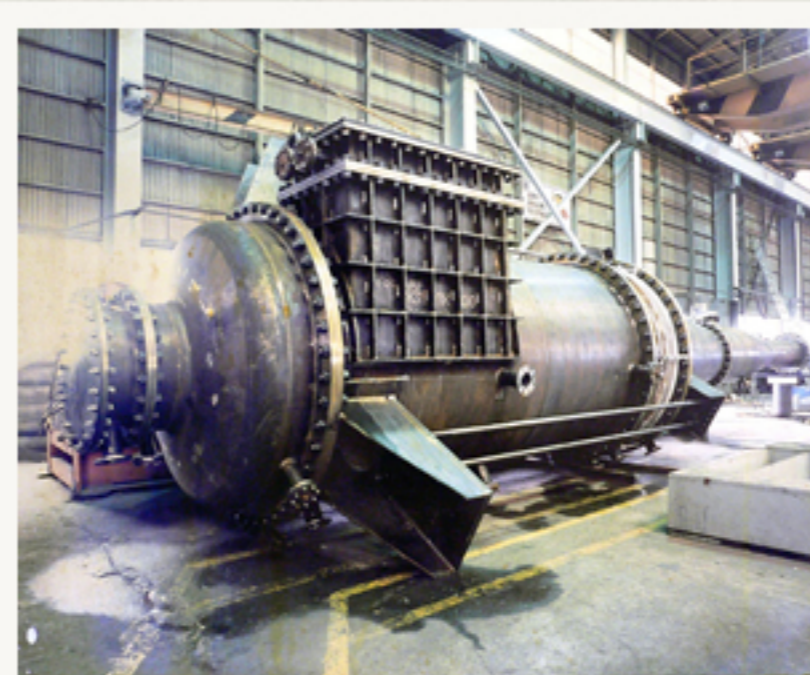
▲還元ガス処理設備 水冷式ホットサイクロン
