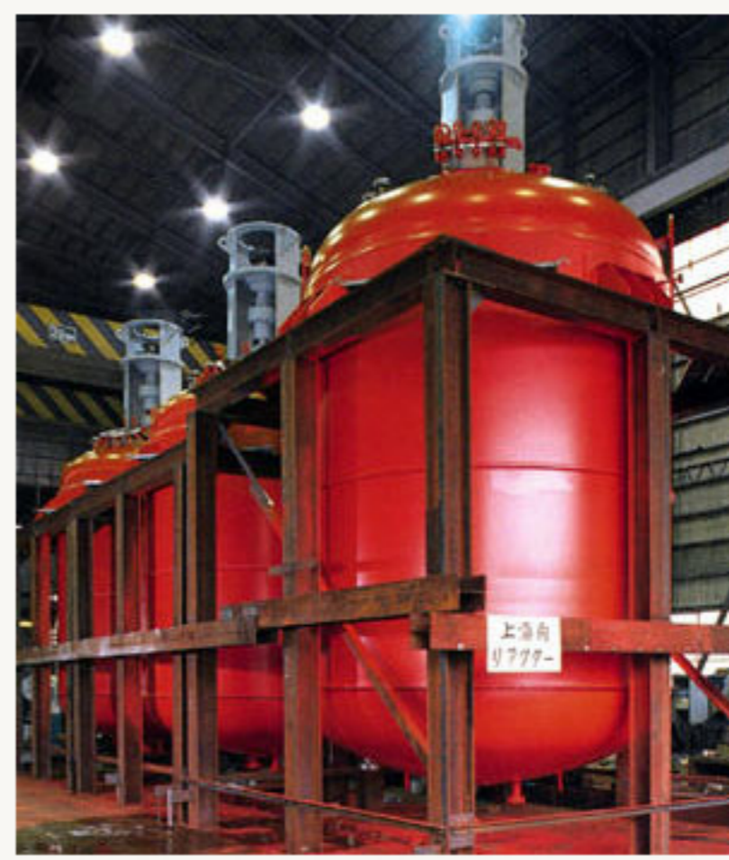
▲輸出攪拌槽及び攪拌機
